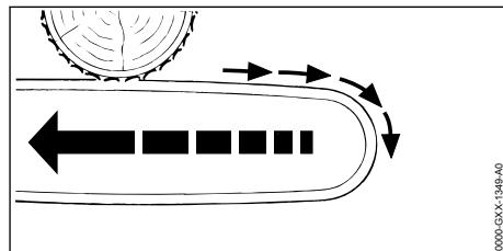
バーの上部を切断に使用すると、ソーが作業者の方向に押し戻されます。
