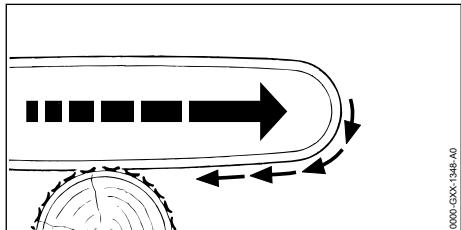
Quando se trabalha com a parte inferior do sabre, a motosserra é puxada para o lado oposto do operador.
