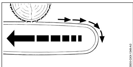
Quando se trabalha com a parte superior do sabre, a motosserra é repulsada na direção do operador.
